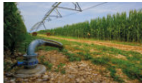
Idrante girevole per alimentazione da manichetta
