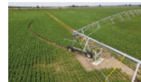
Campata in rotazione sul secondo fulcro
