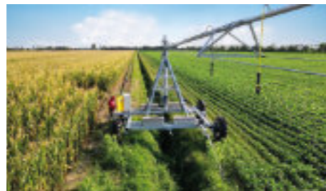
Carro customizzato posizionato sopra fosso
