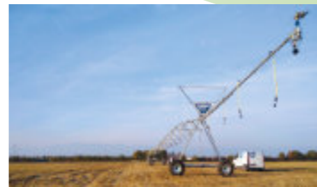
Campata finale con sbraccio e irrigatore
