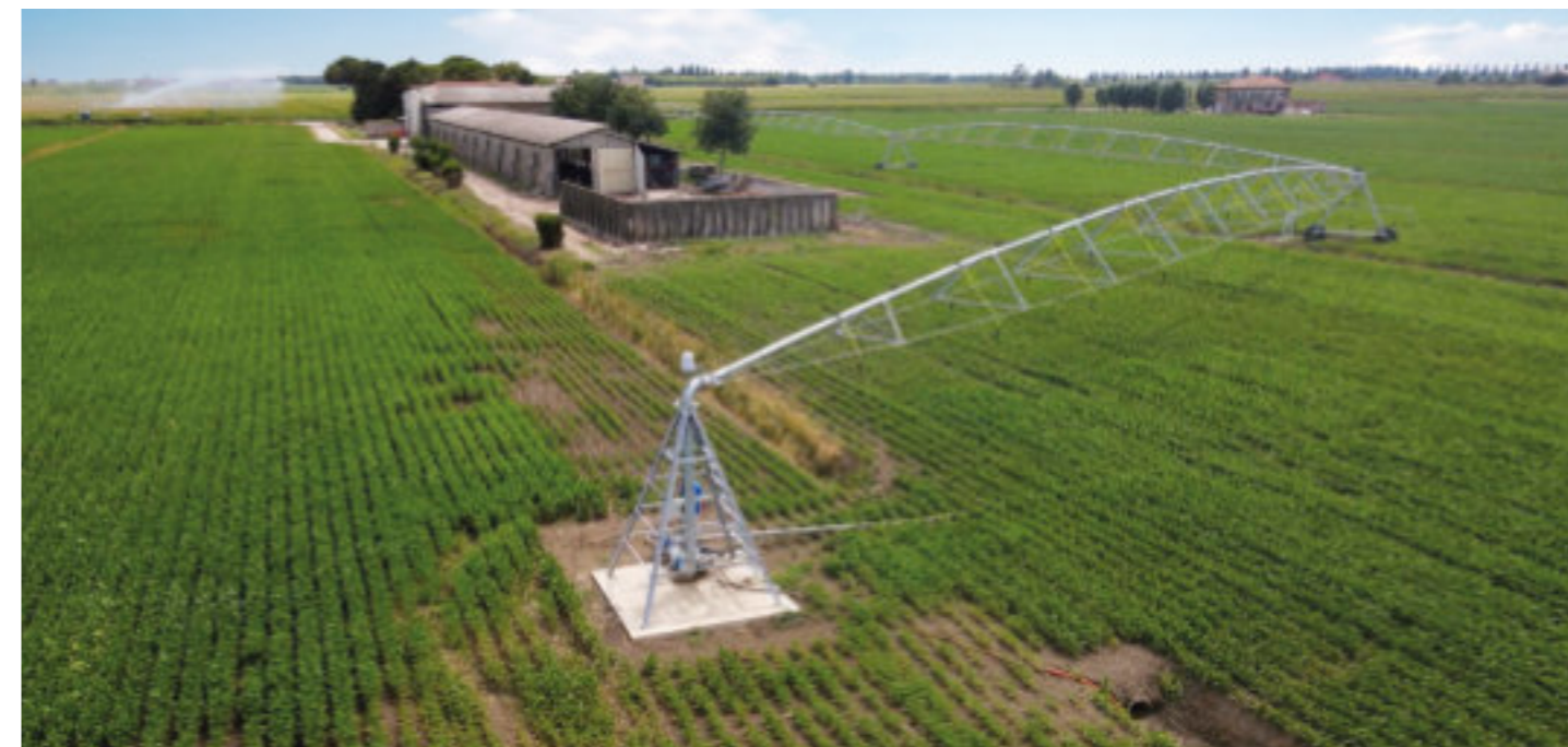
Pivot extender con particolare del primo e del secondo fulcro di rotazione
