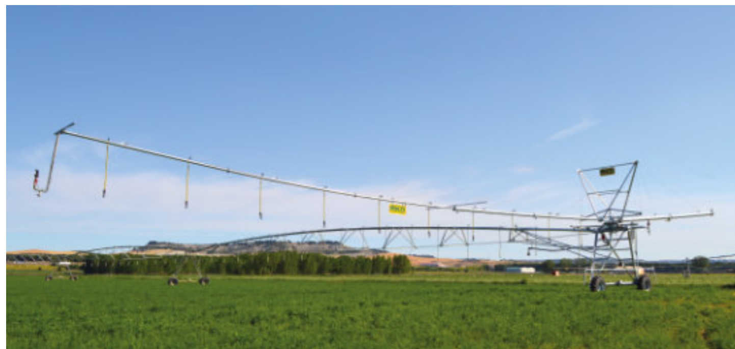
Particolare dello sbraccio wings in posizione chiusa
