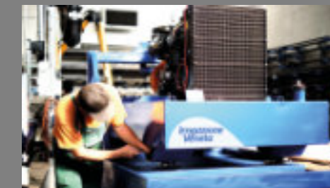
Allattamento di un gruppo motopompa nelle officine di Irrigazione Veneta
