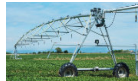
Secondo fulcro di rotazione su torre intermedia
